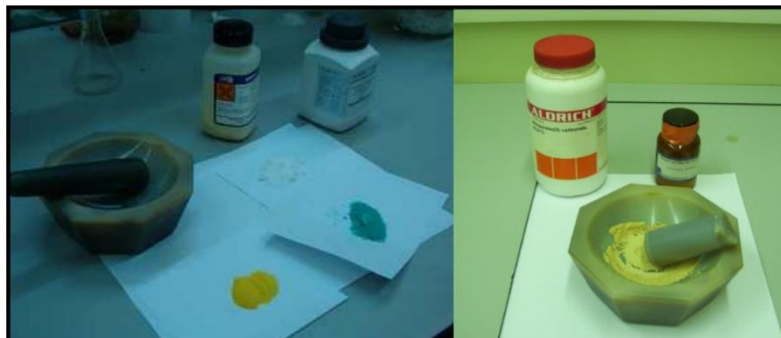
Figura 2.1: Imagem do almofariz de ágata e reagentes utilizados nas sínteses pelo método de cerâmicos. Fonte [61].
