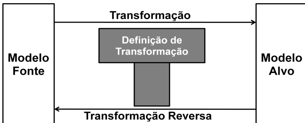
Figura 2.10: Transformação Bidirecional em MDA adaptado de [5]
