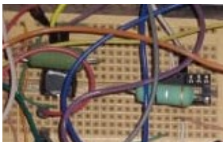
Figura B.7: Protótipo do sensor de corrente. Fonte: o autor.
