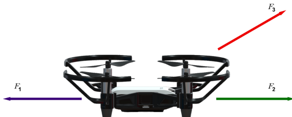
Figura 04: Conjunto de forças atuando em um Drone I
