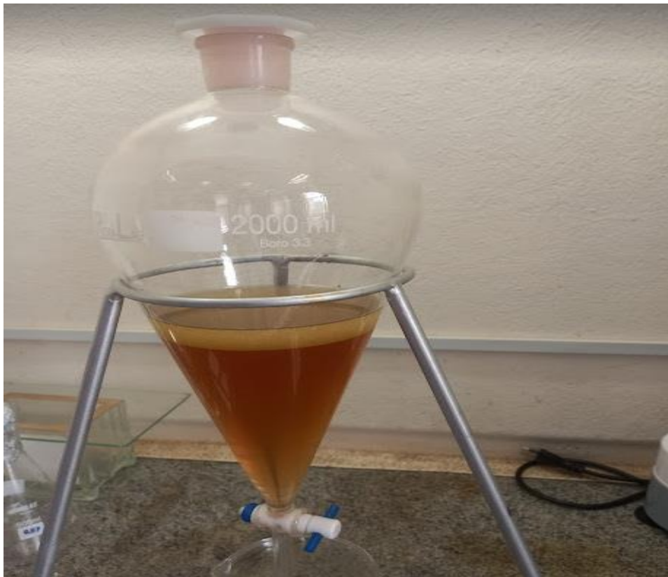
Figura 4 - Partição em funil de separação para obtenção das substâncias químicas a serem testadas
