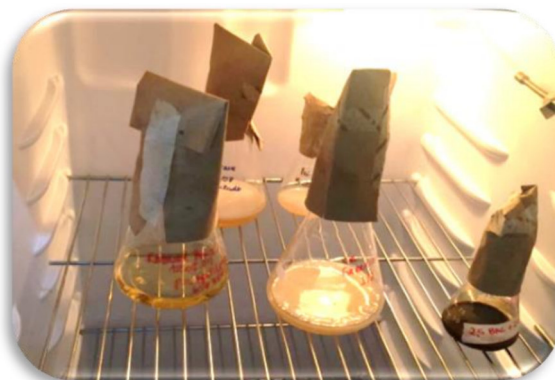
FIGURA 10: Processo de elaboração da biocelulose por K. rhaeticus , etapa de incubação – cultura estática
