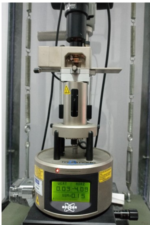
Figura 3.1: Microscópio de Força Atômica Multimode 8 (Bruker, Santa Bárbara, CA) localizado no Laboratório de Biofísica e Nanossistemas da UFMA.
