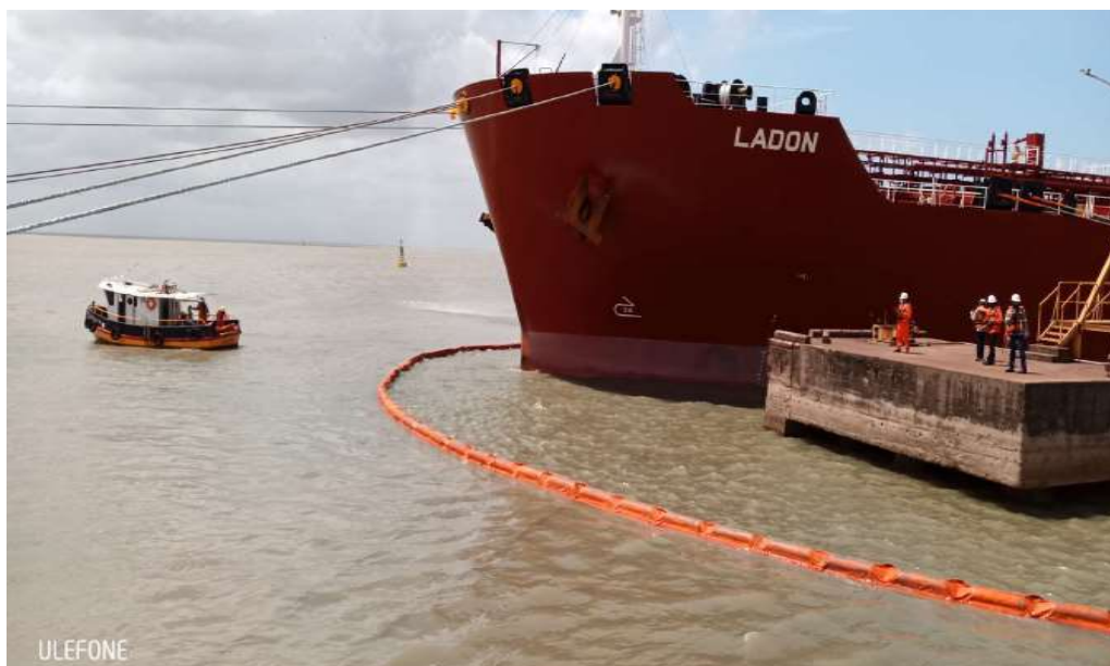
Figura 26 – Cercamento da embarcação para contenção do Diesel.
