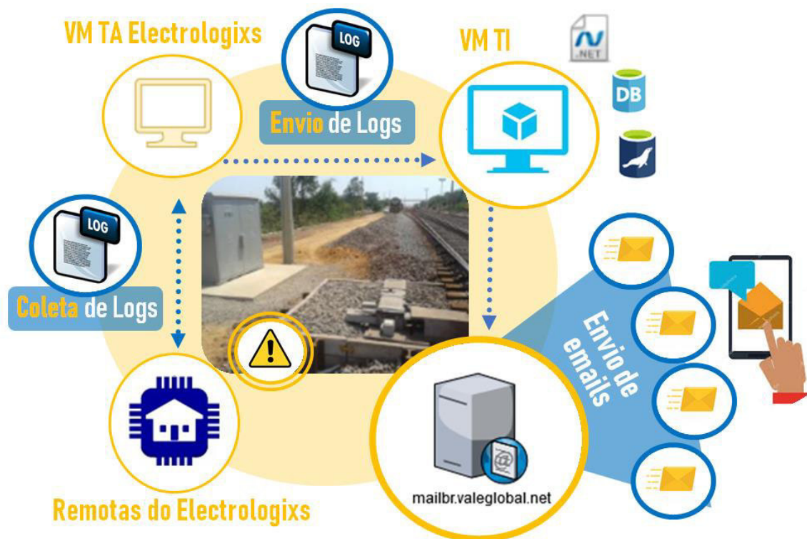
Figura 37 - Arquitetura do Sistema de Alarmes de MCH
