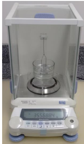
Figura 2-2: Sistema utilizado nas medidas de densidade.
