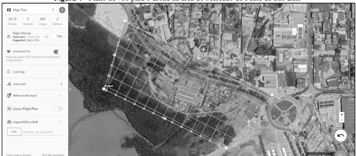
Figura 4 - Plano de voo para o drone na área do Mercado do Peixe de São Luís
