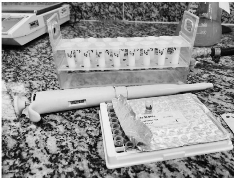
Figura 2 – Kit Eclipse 50 para detecção de resíduos de antibióticos e amostra de leite usadas no teste.
