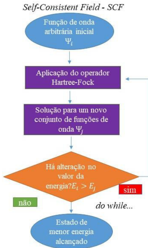
Figura 1. Esquema do método variacional do campo auto-consistente de Hartree-Fock entre duas configurações eletrônicas (i, j) e seus respectivos valores de energia.
