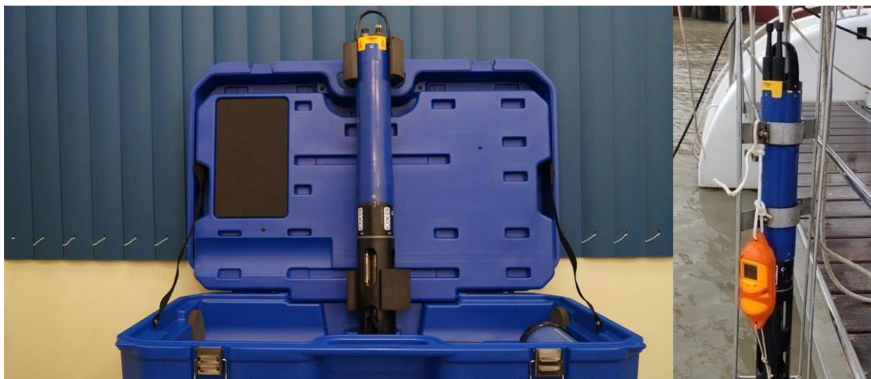
Figura 9. Equipamento utilizado neste estudo: o CTD ( Conductivity, Temperature and Depth ) EXO2, YSI, Ohio, USA acoplado a grade de proteção.
