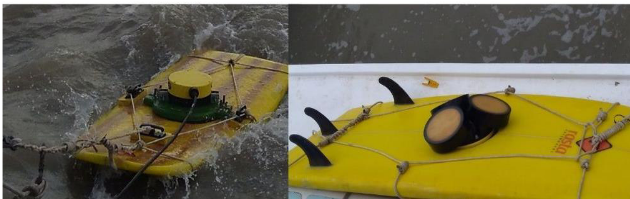
Figura 10. Equipamento utilizado neste estudo: o ADCP ( Acoustic Doppler Current Profiler ) acoplado à prancha e preso por cordas na popa da embarcação.
