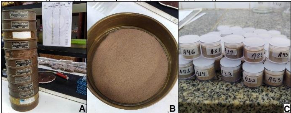
Figura 31 – (A) Conjunto de peneiras; (B) peneiramento; (C) moda granulométrica.
