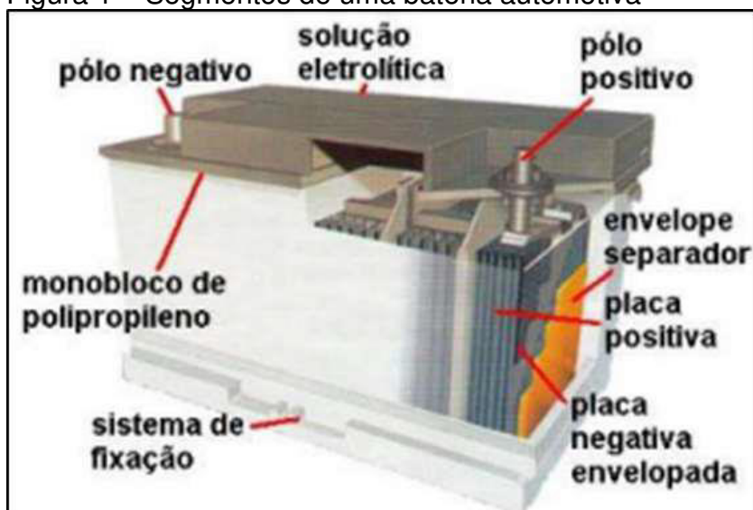
Figura 1 – Segmentos de uma bateria automotiva
