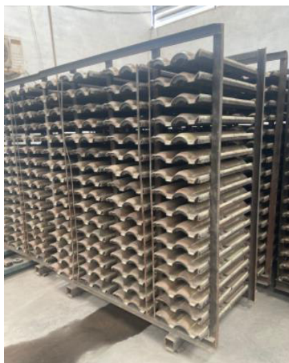
Figura 18: Formas metálicas utilizadas para fabricação das telhas
