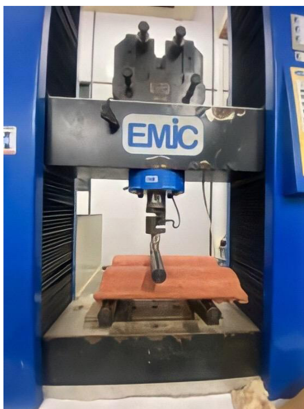
Figura 23: Ensaio de resistência à tração na flexão de telhas
