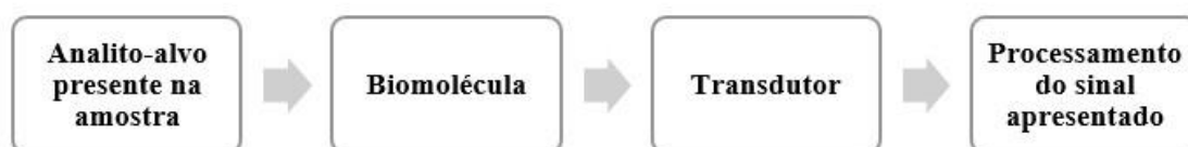
Figura 3 - Representação esquemática dos componentes de um biossensor.
