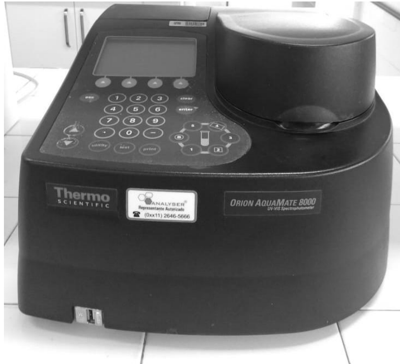
Figura A1 – Foto do espectrofotômetro utilizado para os ensaios cinéticos.
