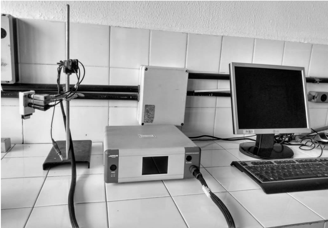
Figura B1 - Potenciostato utilizado para a realização dos ensaios eletroquímicos.
