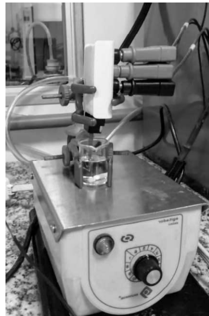
Figura B2 – Fotos do conector feito sob encomenda para acoplamento do biossensor durante os ensaios eletroquímicos.
