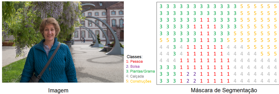
Figura 20 – Exemplo de máscara de segmentação de uma imagem, onde é possível ver que cada pixel representa uma classe.
