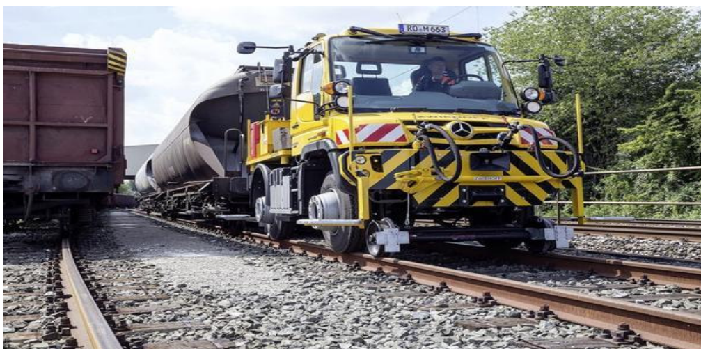
Figura 17 – Ilustração locotrator movimentando cargas em linha ferroviária.
