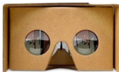
Figura 12 - Fotografia do Google Cardboard mostrando sua estrutura de papelão e as duas lentes que formam imagens estereoscópicas.
