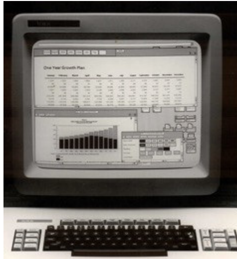
Figura 6 - Fotografia do monitor de um Xerox Star em funcionamento mostrando elementos da GUI.
