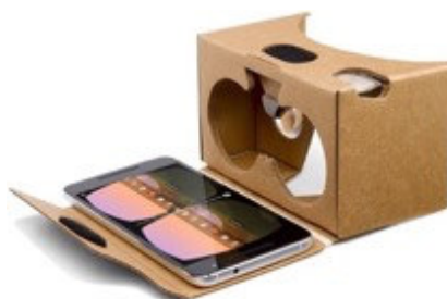
Figura 13 - Google Cardboard aberto, com o espaço para acoplar o celular, cuja tela será o monitor do HMD.
