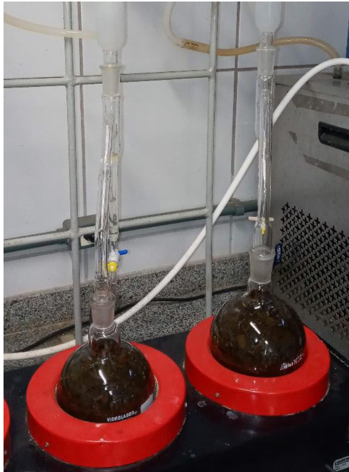
Figura 9. Extração de óleo essencial de Ocimum gratissimum por hidrodestilação em extrator do tipo Clevenger modificado.
