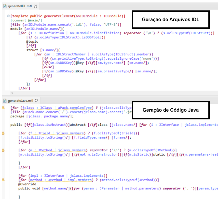
Figura 5.15 – Um trecho dos templates para geração de texto no FMDE4SGRID-runtime utilizando o Acceleo.
