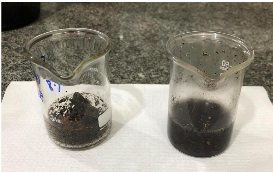
Figura 16: Amostra resultante da mistura de resina com acréscimo de adubo vegetal - (direita) secou em ambiente aberto / (esquerda) secou na estufa a 90° C.
