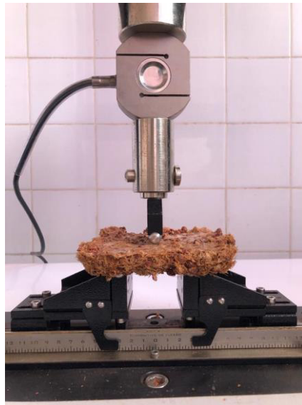
Figura 37: Ensaio de 3 pontos das amostras.
