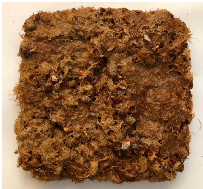
Figura 28: Amostra produzida com resina da quarta fase – com acréscimo de 70% de material.
