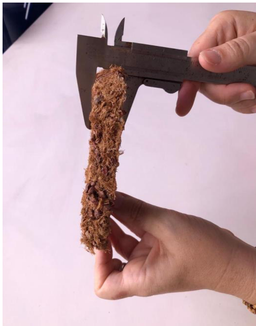
Figura 36: Aferindo a espessura das peças.
