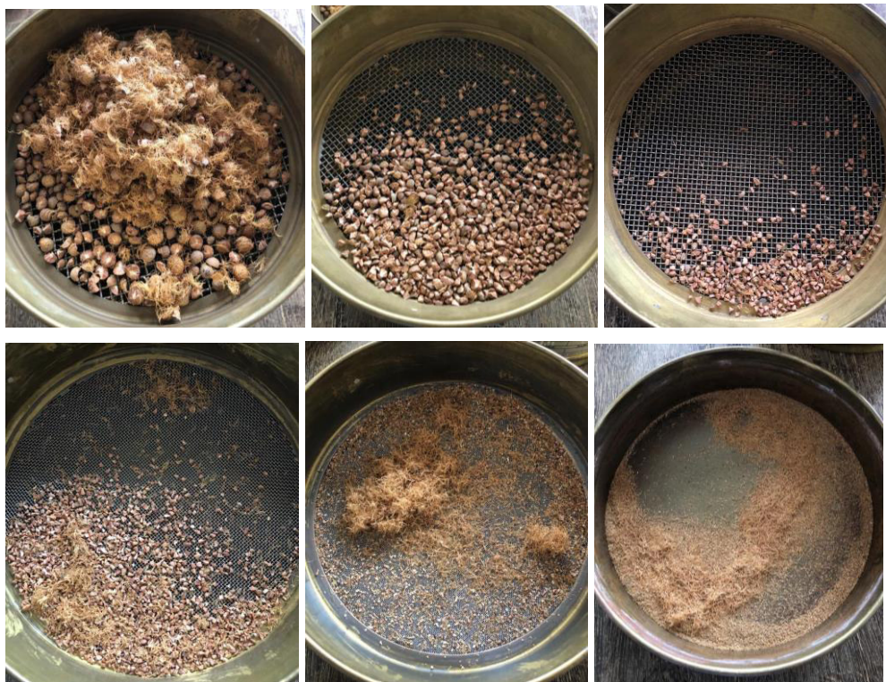
Figura 25: Material retido nas peneiras de mesh 4, 7, 8, 14, 28 e fundo.
