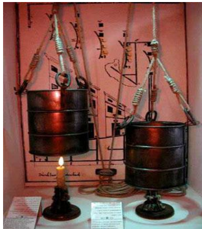
Figura 14 – Réplica do primeiro dimmer da iluminação cênica Fonte: History 18th Century Footlight Lamp. 2010
