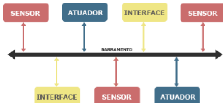
Figura 3-3: Sistema de automação distribuído
