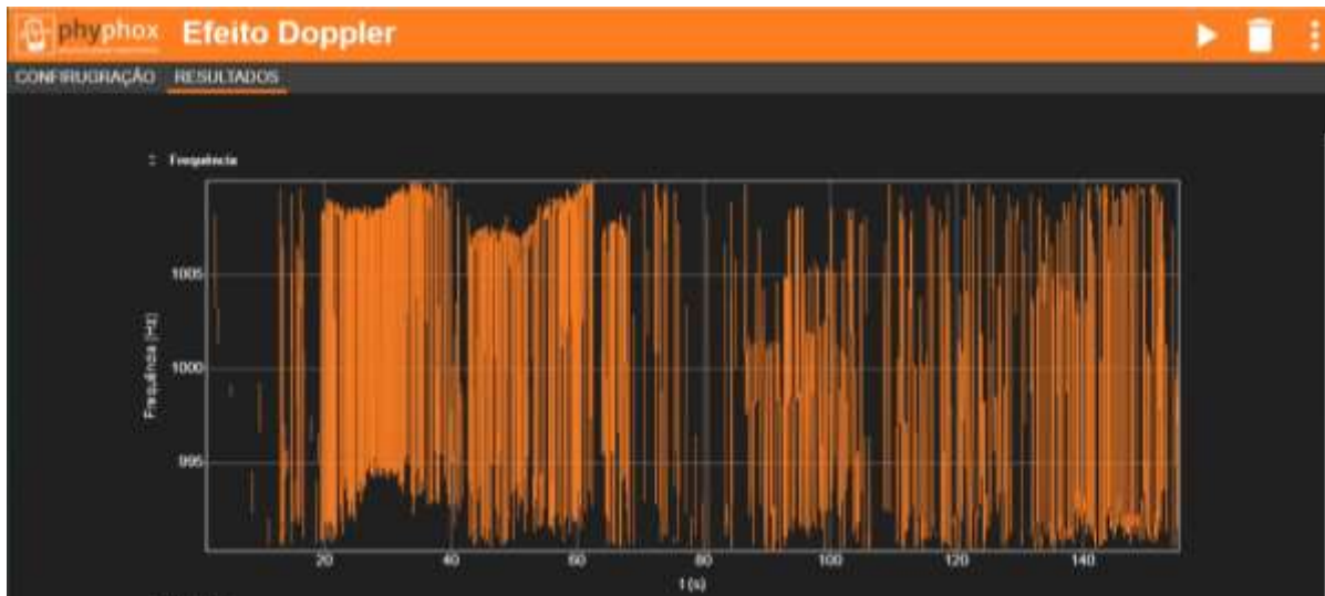
Figura 25 – Gráfico gerado a partir do movimento da fonte sonora em direção ao observador.
