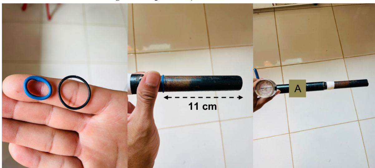
Figura 11. Liga de vedação sendo fixada na base
