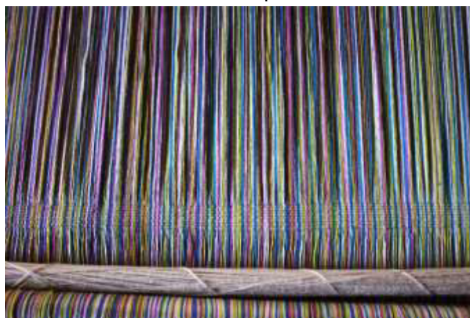
Figura 43: Tear com a urdidura pronta da técnica de 15 cores
