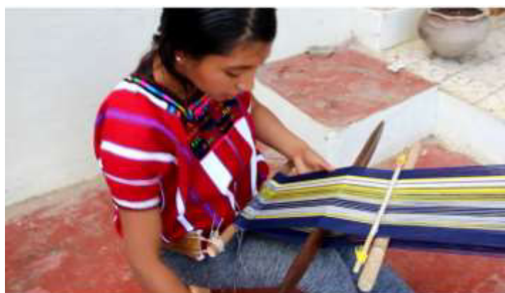
Figura 16: Fixação da urdidura
