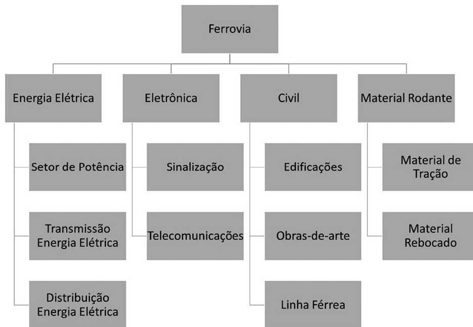
Figura 1 – Fluxograma de subsistemas de ferrovia.
