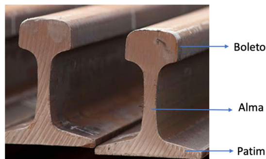
Figura 3 – Representação esquemática da composição de trilho.
