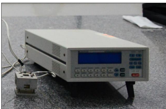
Figura 23. Mini forno de alumínio e controlador de temperatura marca Lakeshore Modelo 335 (Laboratório de Espectroscopia Raman - UFMA).
