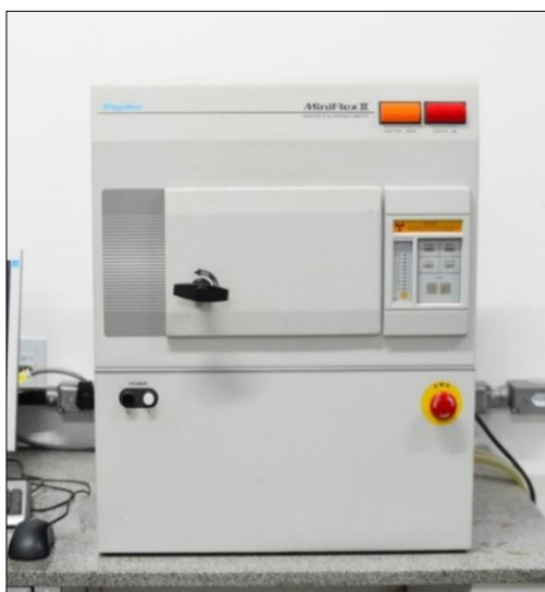
Figura 19. Difratômetro Rigaku Modelo Miniflex II (Laboratório de Difração de Raios X - UFMA).
