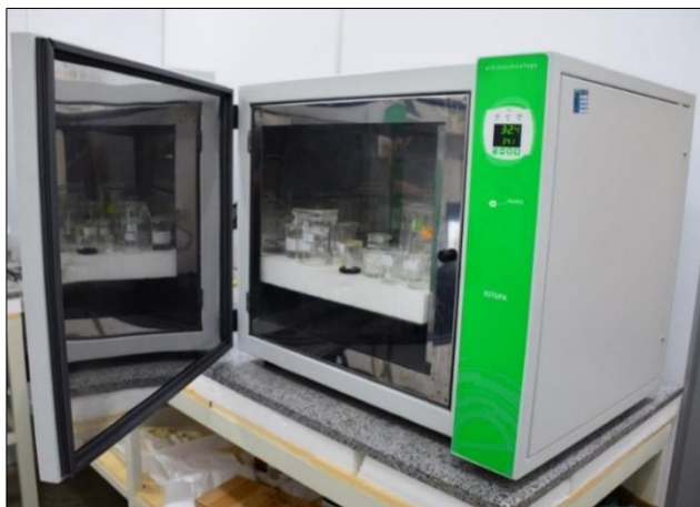
Figura 18. Estufa de aquecimento utilizada para crescimento de cristais por solução (Laboratório de Espectroscopia Raman - UFMA).
