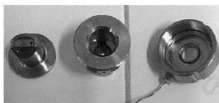
Figura 27. Célula de Pressão Diamond Anvil Cell com membrana (Laboratório de Física de Materiais e Altas Pressões - UFC).
