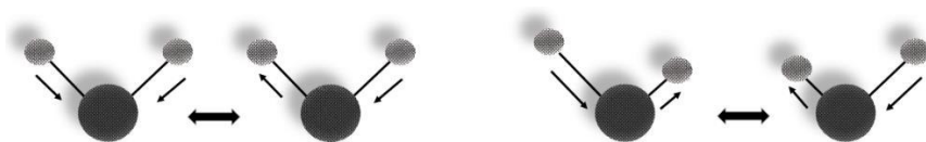
Figura 23 - Representação dos modos vibracionais do tipo stretching . As setas representam movimento no plano igual ao da folha de papel. Adaptado de [103].
