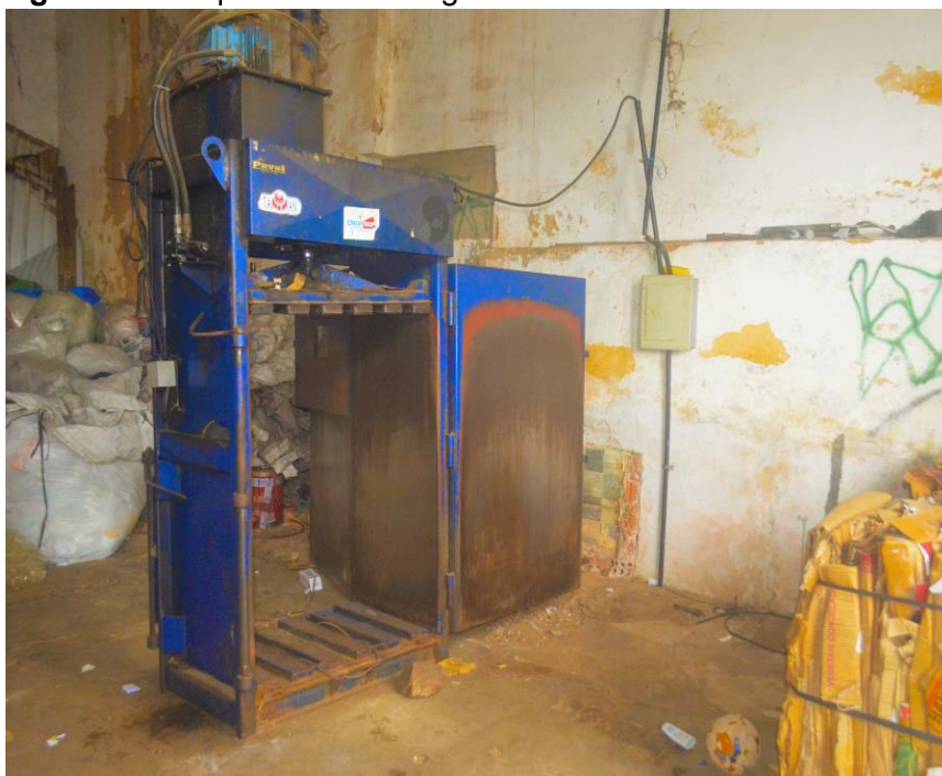
Figura 9 – Máquina de Prensagem da ASCAMAR
