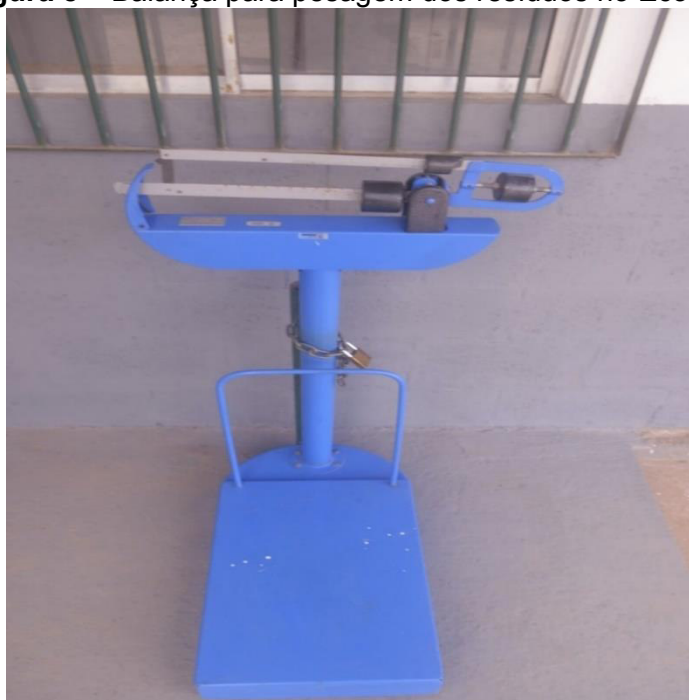
Figura 8 – Balança para pesagem dos resíduos no Ecoponto
