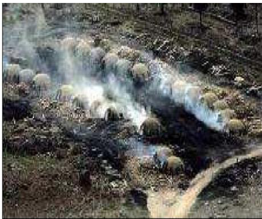
Figura 7 - Processo típico e seu melhoramento: (a) Queima a céu aberto e (b) Fornos de tijolos com chaminés.
