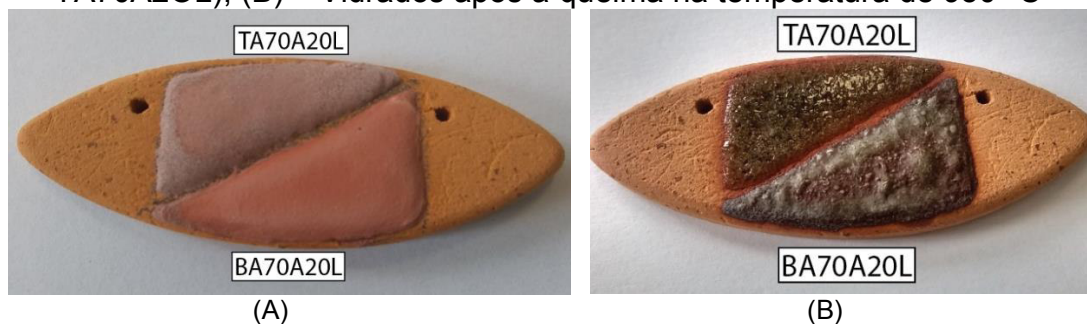
Figura 40 – (A) – Peça cerâmica pintada com as composições (BA70A20L e TA70A20L); (B) – Vidrados após a queima na temperatura de 950 °C
