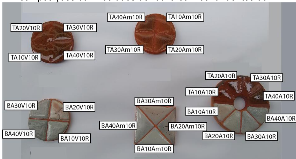
Figura 42 – Vidrados após sinterização de 950 °C das composições de as composições com resíduos de rocha com os fundentes do BA e as composições com resíduos de rocha com os fundentes do TA
