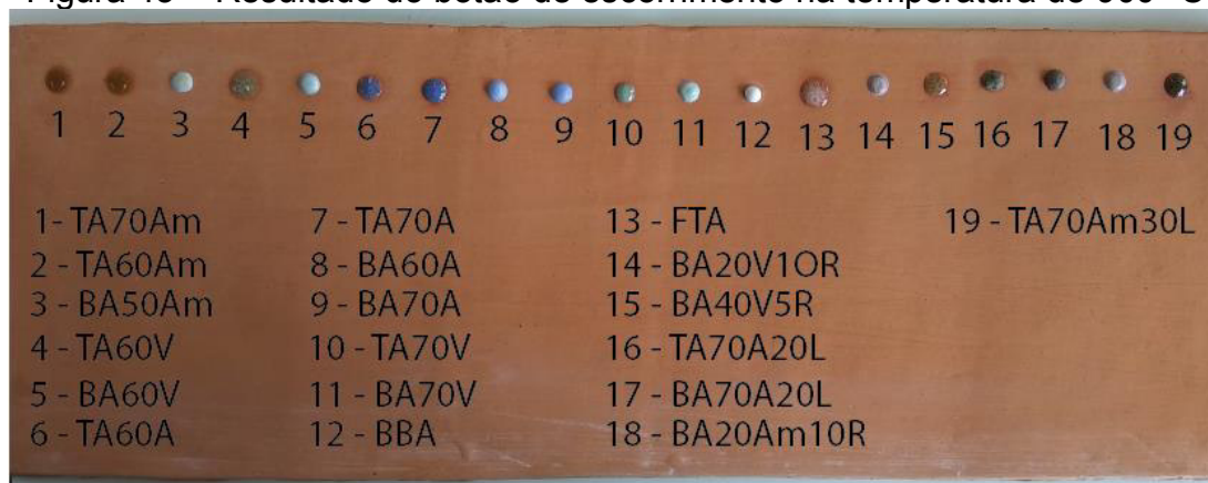
Figura 43 – Resultado do botão de escorrimento na temperatura de 900 °C
