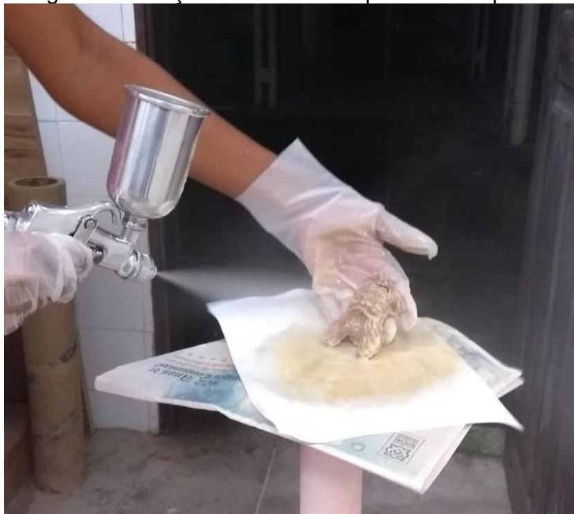
Figura 21 – Peça cerâmica sendo pintada com pistola
