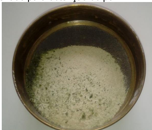
Figura 11 – (A) – Vidro âmbar sendo triturado no moinho tipo martelo; (B) – Vidro verde sendo peneirado para obtenção do pó.
