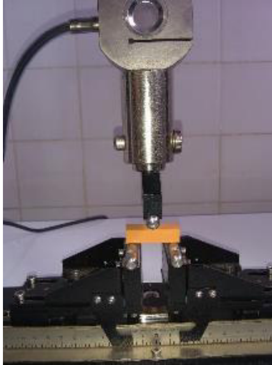
Figura 48 – Os corpos de prova submetidos ao teste de flexão
