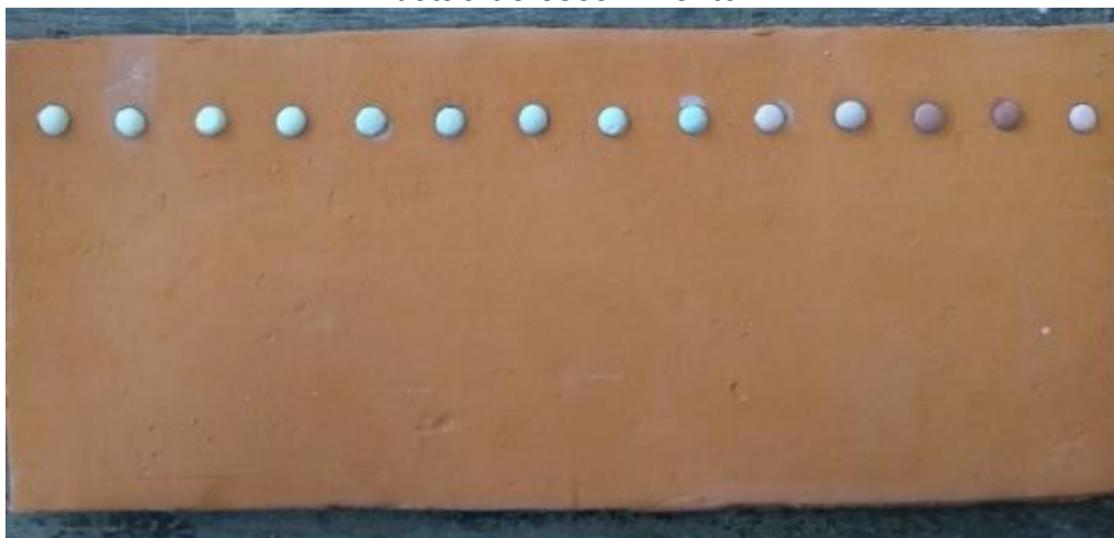
Figura 14 – Placa cerâmica com as composições pintadas para o teste de botão de escorrimento
