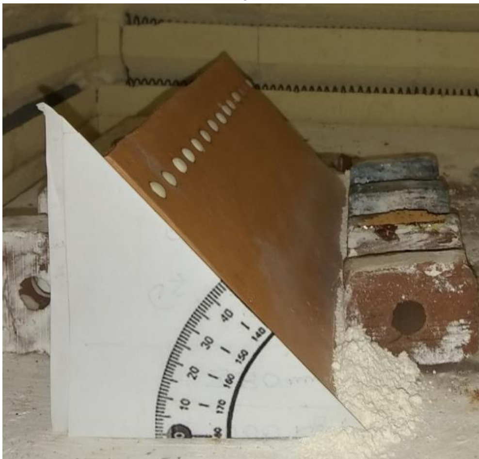
Figura 15 – A placa pintada pronta para sinterização de 900^\circ\text{C} no ângulo de 45^\circ
