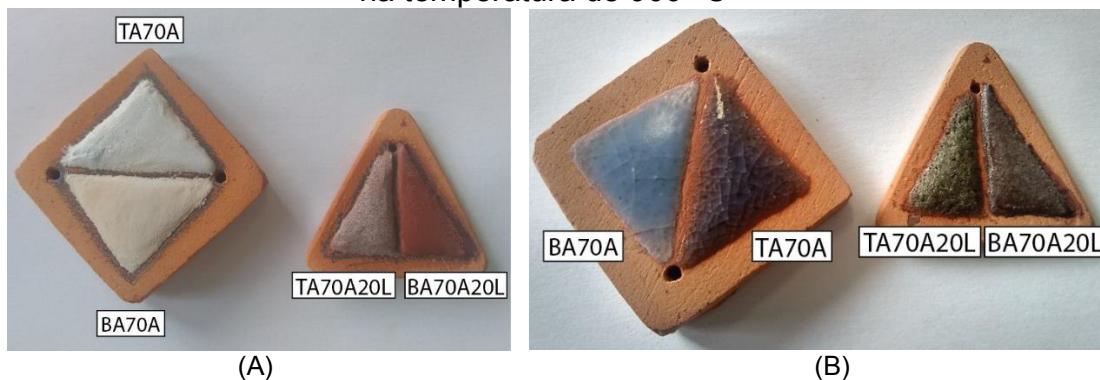
Figura 39 – (A) – Peças cerâmicas pintadas com as composições (BA70A20L e TA70A20L) e (BA70A e FA70A); (B) –Vidrados após a queima na temperatura de 900 °C
