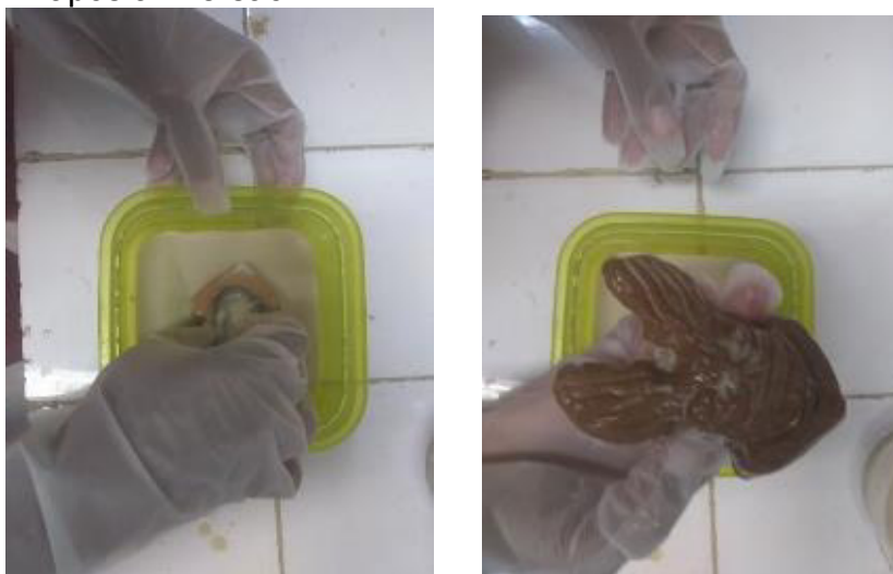
Figura 49 – (A) – Imergindo a carranca na composição TA70V; (B) – Carranca após a imersão.
