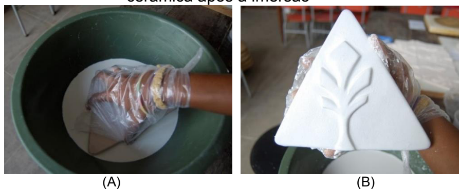
Figura 19 – (A) – Imergindo a peça no óxido Transparente fundente; (B) – Peça cerâmica após a imersão
