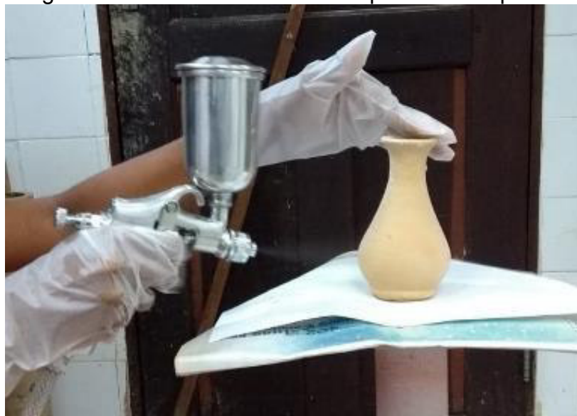
Figura 51 – Vaso cerâmico sendo pintado com pistola
