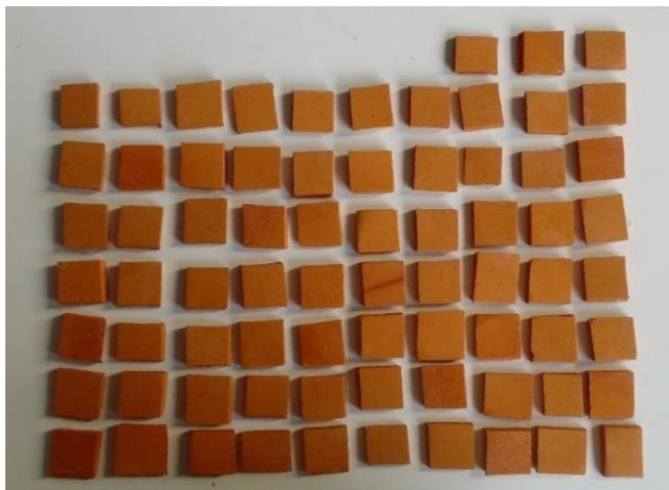
Figura 22 – Pastilhas cerâmicas após sinterização de 980 °C
