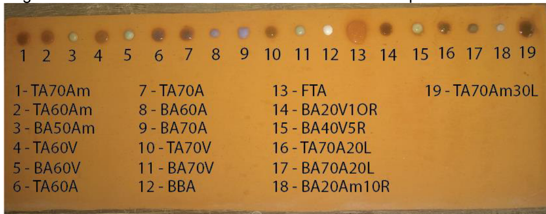
Figura 45 – Resultado do botão de escorrimento na temperatura de 950 °C
