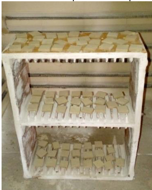
Figura 10 –Pastilhas no forno para serem queimadas a 980 °C
