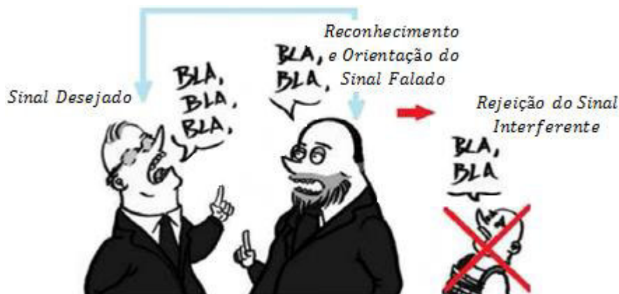
Figura 4.6: Analogia de funcionamento das Antenas Inteligentes (Adaptado de [55]).
