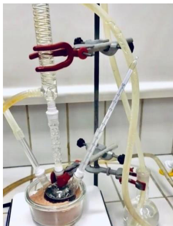
Figura 13: Sistema reacional para produção das nanopartículas \text{CoFe}_2\text{O}_4@Ag .
