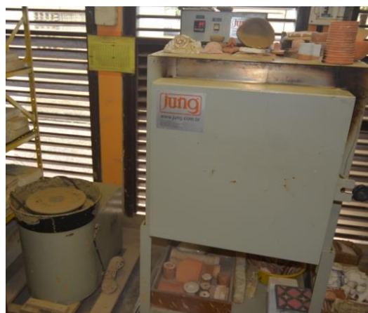
Figura 38: Forno e torno lab. de cerâmica UFMA
