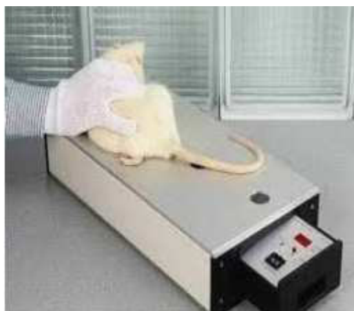
Figura 04. Aparelho placa quente ( hot plate ) utilizado no Laboratório de Estudo Experimental da Dor/Universidade Federal do Maranhão Fonte: autor
