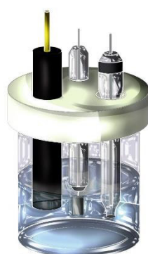
Figura 2 - Célula eletroquímica com os eletrodos de trabalho CV, auxiliar Pt e referência Ag/AgCl e agitador magnético.
