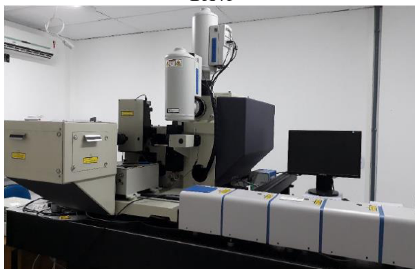
Figura 20 – Espectrômetro T64000, marca HORIBA Jobin-Yvon e equipado com microscópio Olympus BX41
