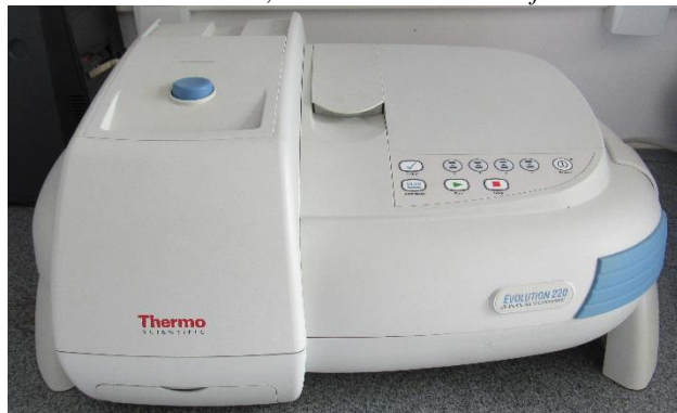
Figura 23 – Espectrofotômetro UV-Vis, marca Thermo Scientific e modelo 220 UV Evolution
