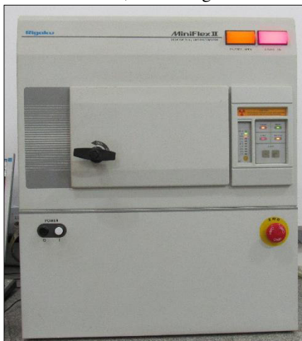
Figura 17 – Difratorômetro de Raios X, marca Rigaku e modelo MiniFlex II
