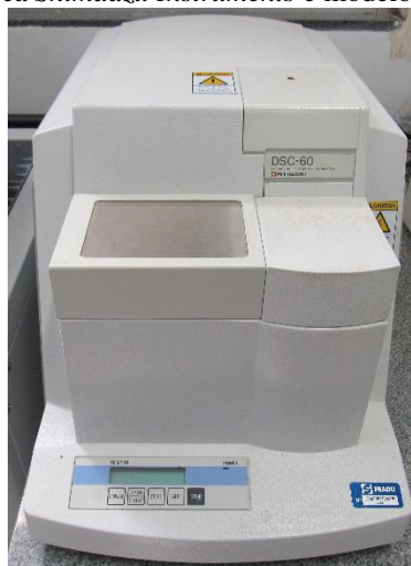
Figura 22 – Calorímetro, marca Shimadzu Instruments e modelo DSC-60, com detalhe do forno
