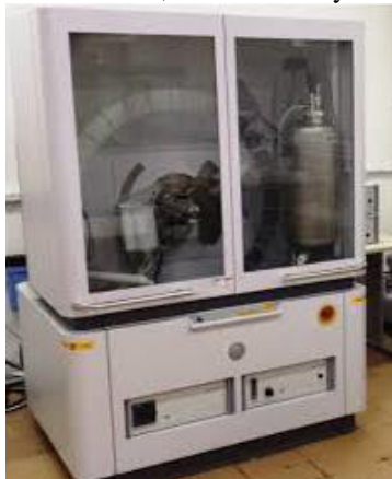
Figura 18 – Difratorômetro de Raios X, marca PANalytical e modelo EMPYREAN
