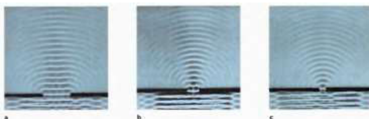
Figura 20: Fenômeno da difração numa fenda em uma cuba d'água.
