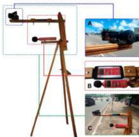
Figura 23: Sistema utilizado para suportar os equipamentos. (A) Câmera de registro do Tráfego; (B) Suporte do celular e do medidor de nível sonoro; (C) exemplo de como o sistema ficou durante a coleta de dados. Fonte: própria.
