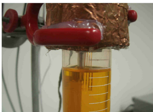
Figura 53 – Detalhe dos sensores de temperatura (esq.) e lâmina de eletrodos interdigitados (dir.)
