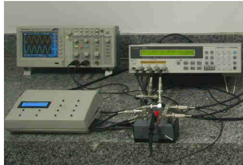
Figura 45 – Arranjo de equipamentos utilizado para medição do capacitor cerâmico durante teste funcional.
