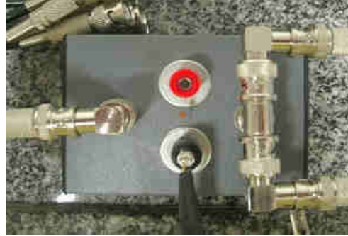
Figura 44 – Detalhe de ligação do capacitor cerâmico durante as medições.
