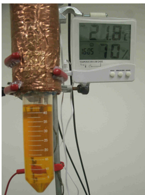
Figura 52 – Detalhe de amostra de combustível posicionada para medição.
