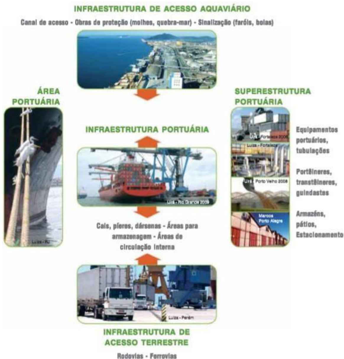
Figura 03 – Infraestrutura e superestrutura portuária.
