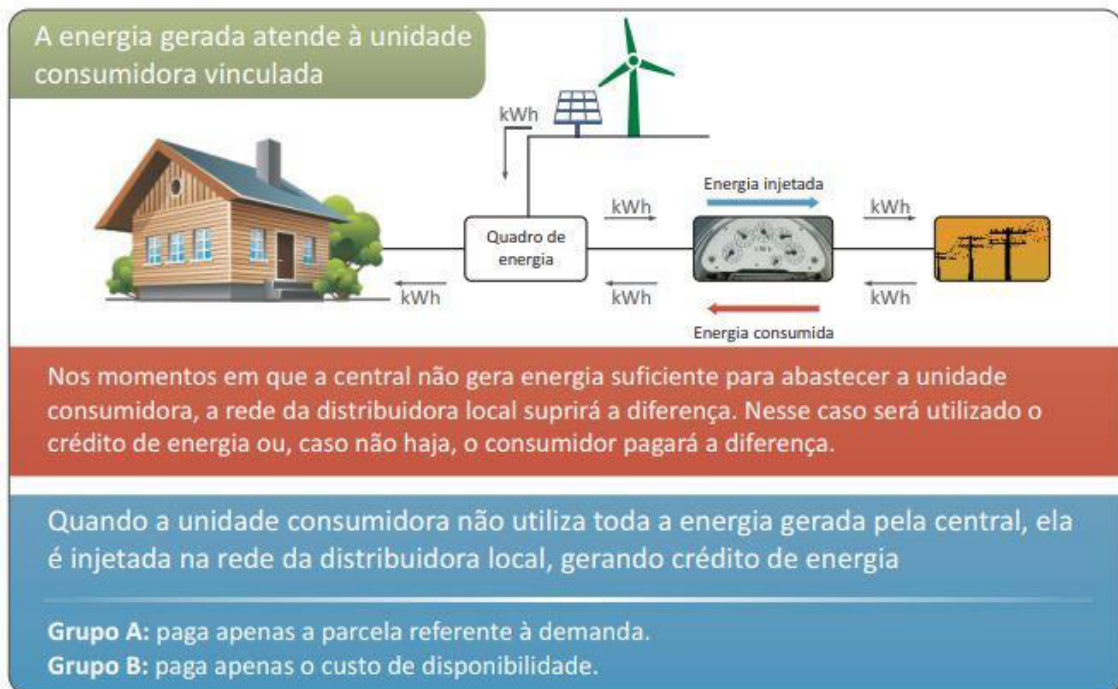
Figura 5 - Sistema de compensação de energia
