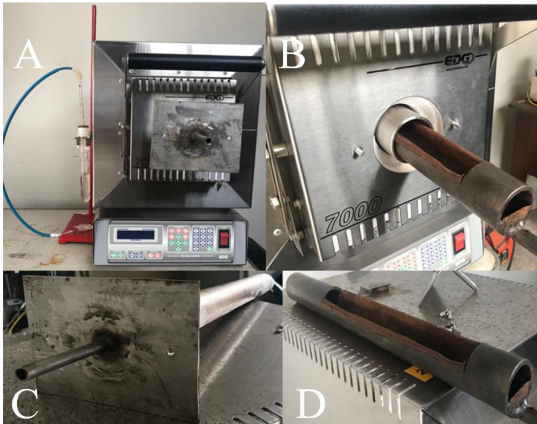
Figura 3 - Reator construído para o processo de queima sob atmosfera de nitrogênio
