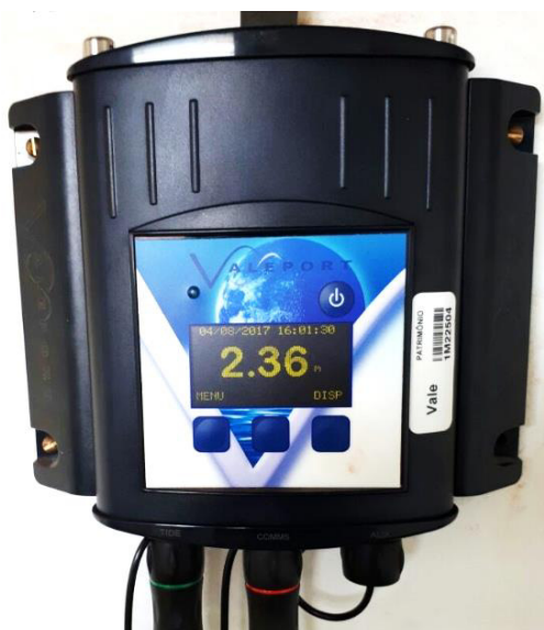
Figura 19. Marégrafo de pressão TideMaster Fonte: Vale S/A (2018)
