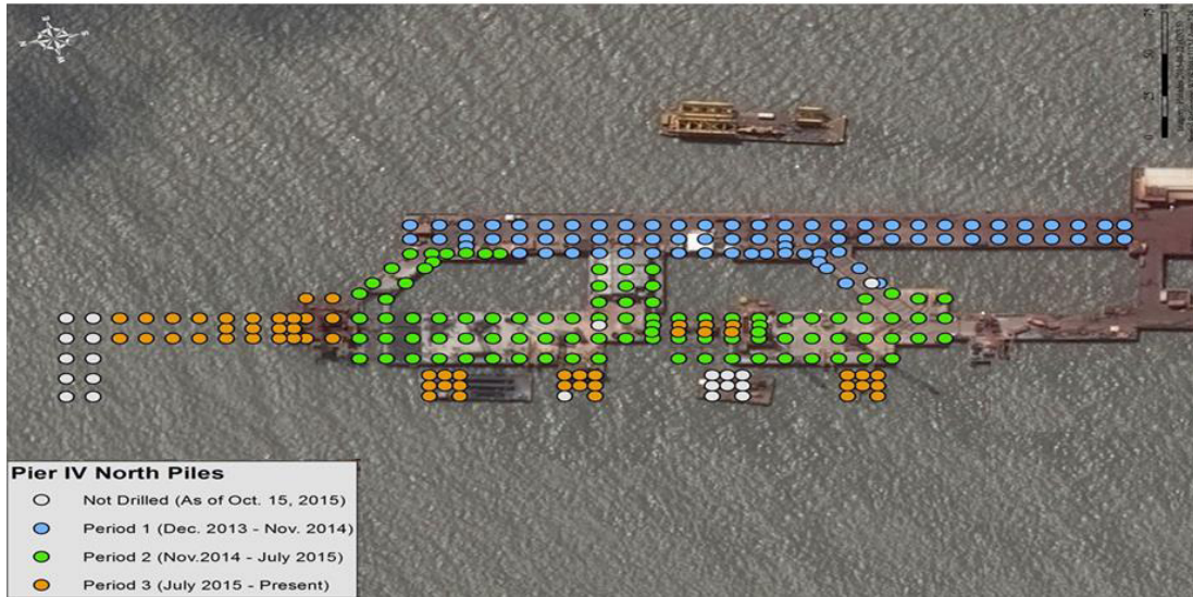
Figura 30. Esquemático com ilustração evolutiva da fase de cravação das estacas.
