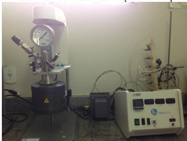
Figura 13 - Equipamento Reator Parr utilizado nas reações com aquecimento convencional
