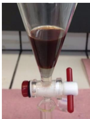
Figura 45 - Produto reacional da eterificação da glicerina de babaçu utilizando aquecimento convencional
