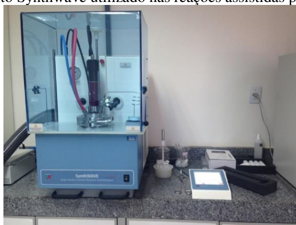
Figura 14 - Equipamento Synthwave utilizado nas reações assistidas por micro-ondas
