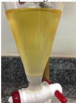
Figura 54 - Produto reacional da eterificação da glicerina de babaçu assistida por micro-ondas
