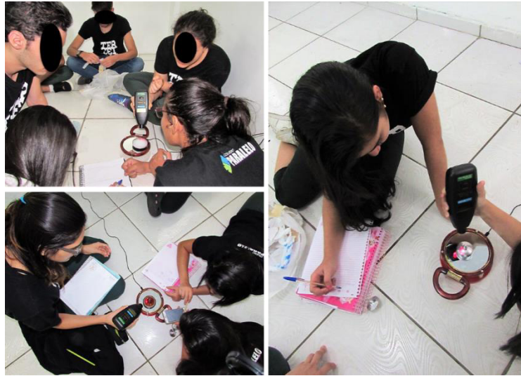
Figura 52. Alunos fazendo a medição da velocidade angular do pião.
