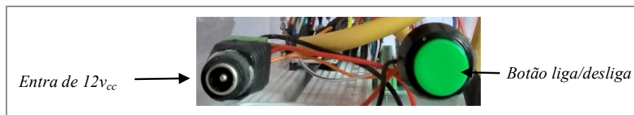
Figura 6 – Entrada de fonte de 12v_{cc} e botão liga/desliga do Elettroduino.
