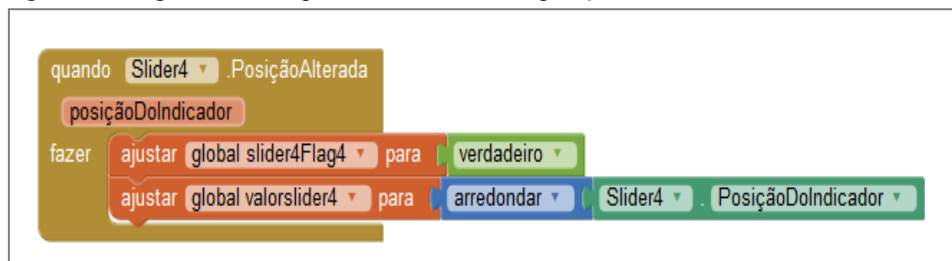
Figura 37 – lógica de bloco para obter o valor das posições do cursor do botão “Slider 4”.
